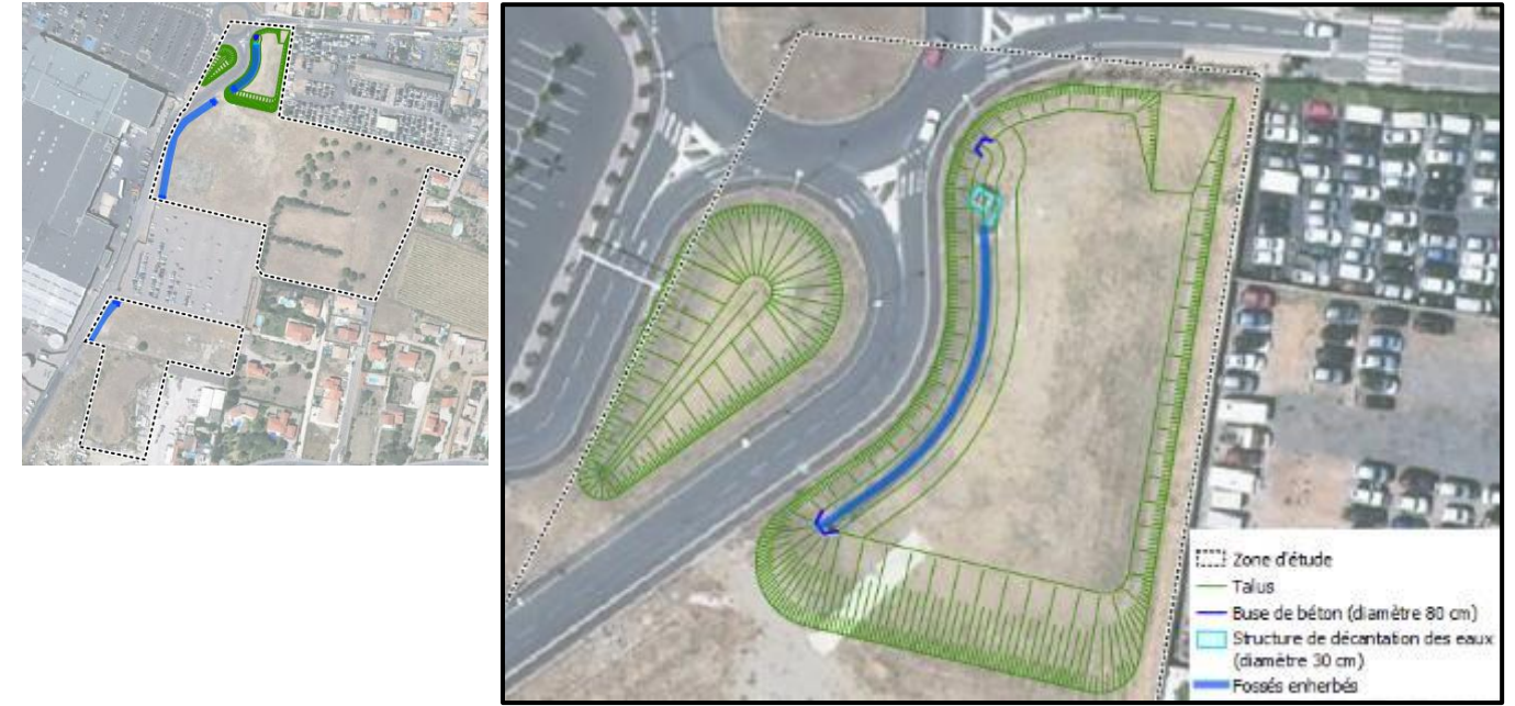
Zoom sur les éléments présents au sein des bassins de rétention au nord de la zone d'étude
